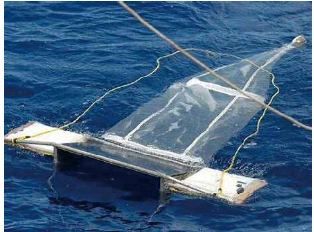
サンプリング用ネット (マンタに似ているためマンタネットとも呼ばれる)
